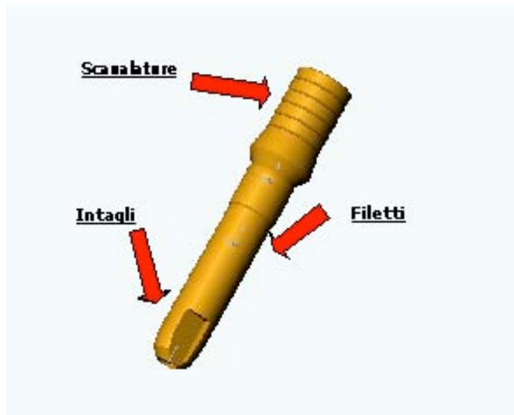
Figura 5.1-2. Elementi che sono stati trascurati nell'elaborazione del modello.
