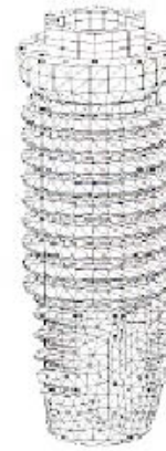
Figura 2.7-2. Esempio di uno studio di un modello di impianto tramite l'analisi ad elementi finiti.
