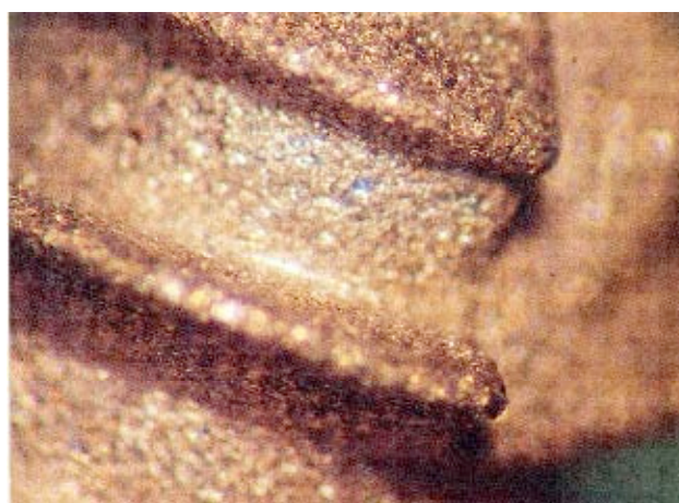
Fig.2.8.1-2 Superficie titanio a maggiore ingrandimento
