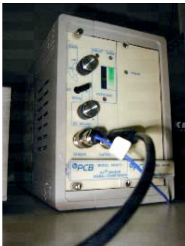
Figura 4.2.6-2. Condizionatore di segnale per la cella di carico: caratteristiche tecniche.
