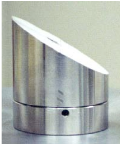
Figura 4.4.1-2. a. Supporto impianto 30°
