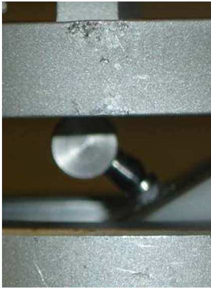
Fig. 5 Impianto sottoposto a carico quasi-statico. Si può notare come sotto la spinta della piastra di carico il moncone inizi a piegarsi.
