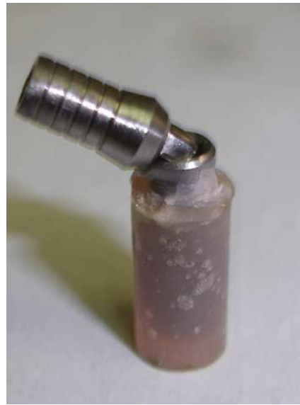
Fig. 6 Rottura del sistema sottoposto a carico quasi-statico. Si può osservare la deformazione della fixture e come il moncone si sia sfilato dall'impianto prima della completa rottura.
