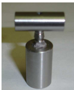
Fig. 9 Cilindro per la distribuzione del carico
