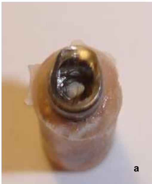
Fig. 7 Rottura della vite di connessione durante le prove "quasistatiche": nella parte inferiore della vite, dove si impegna nella filettatura dell'impianto( a ), e appena sotto la testa della vite ( b ). Si può notare la deformazione del colletto dell'impianto e la deformazione del fusto della vite( b ).
